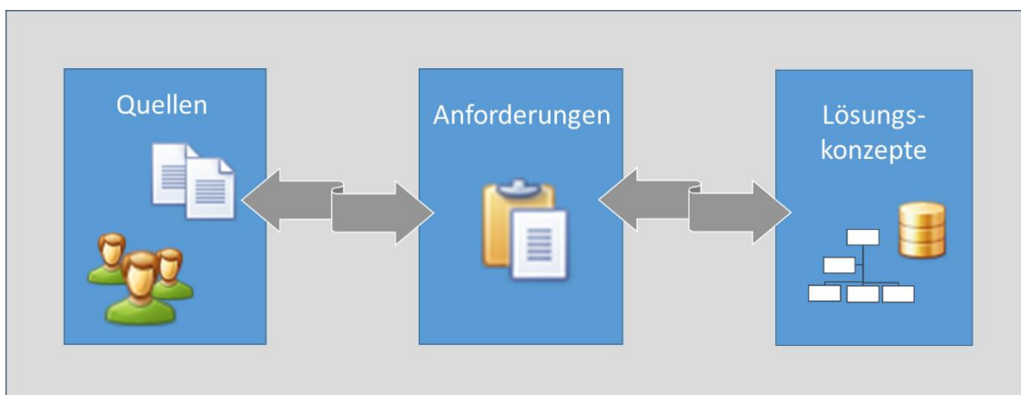
Abbildung 1: Rückverfolgbarkeit (Traceability) der Anforderungen über den Entwicklungsprozess
